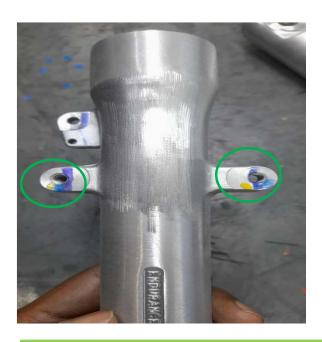
ENSURE THAT, THREADING M6X1-6H OPERATION
